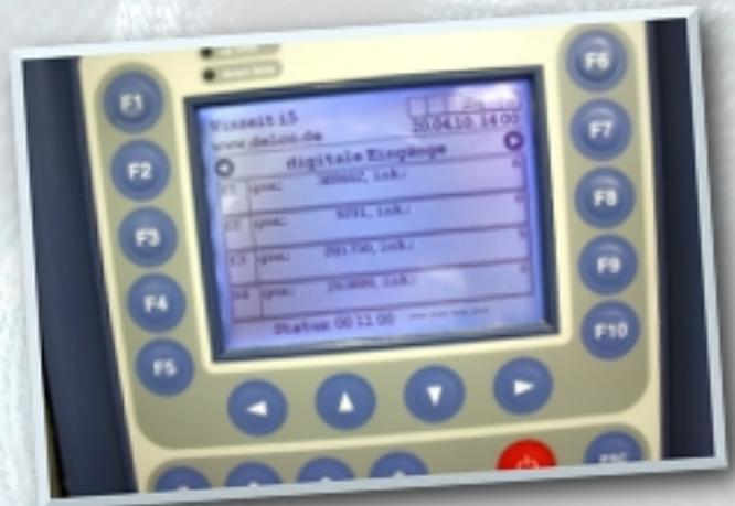
Dank der großen Flexibilität sowohl der Datafox „AE Master IV“-Erfassungsterminals als auch der DELCO „WinZeit i5“-Software werden an mehreren Maschinen die Zählerstände für Gas, Weichwasser und Hartwasser in laufenden Intervallen ermittelt und in einer zusätzlichen Auswertung bereit gestellt.
